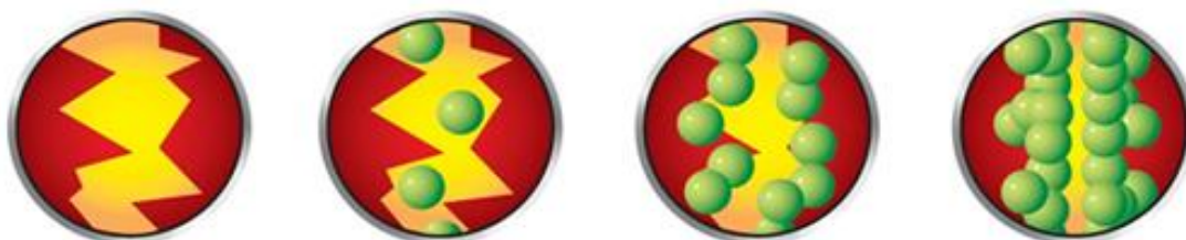
Рис. 1. Етапи ревіталізації в зоні тертя «метал – метал» і утворення захисної плівки,
