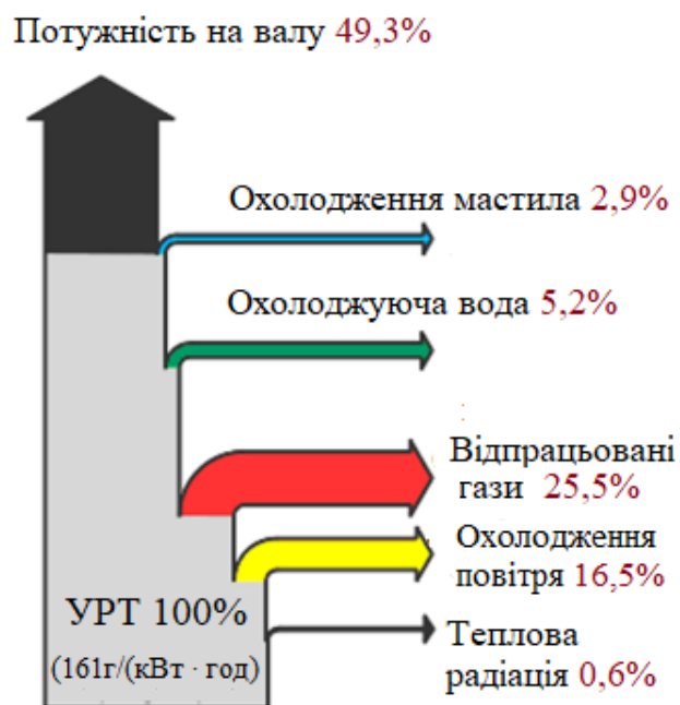
Рисунок 1 – Тепловий баланс ГД із системою утилізації тепла та без неї
