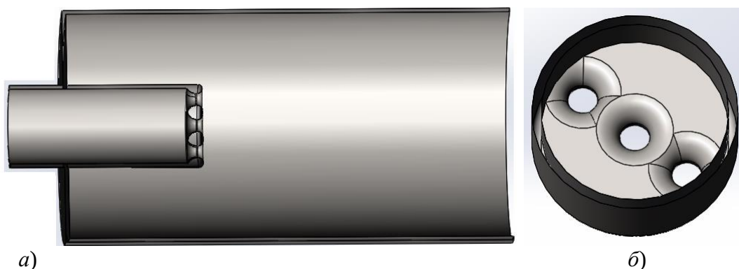
Рисунок 3 – Модель головки GIV зі збільшеною товщиною стінки (модель 2): а – повздовжній переріз; б - отвори в головці CIV при збільшеній товщині стінки
