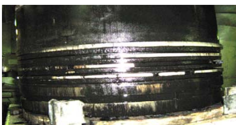
Рис. 4. Поршень двигуна MAN B&W 7S60MC-C з полонаними 3 і 4 кільцями.
