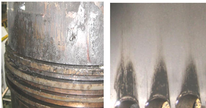
Рис.4. Состояние деталей ЦПГ № 1 (базовый) в конце испытаний
