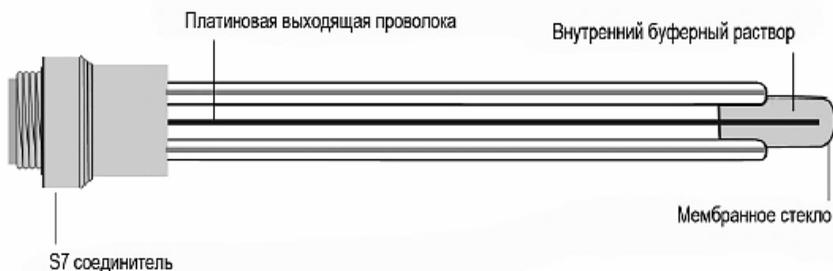
Рис. 2. Схема  $pH$ -электрода с чувствительной мембраной
