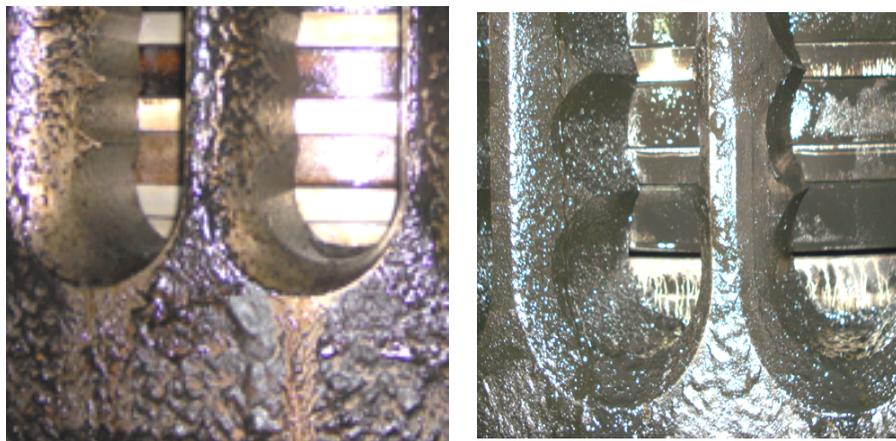
Рис. 7. Нагарообразования на деталях ЦПГ № 3 (экспериментальный) и № 7 (базовый)
