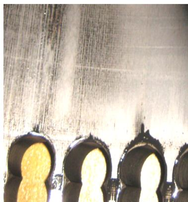
Рис.3. Состояние деталей ЦПГ № 3 (экспериментальный) в конце испытаний
