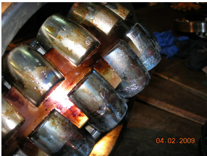
Рис. 2. Характерный вид разрушения подшипников качения
